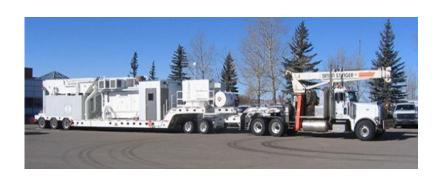
ASE50B 燃气轮机体积精巧,功能广泛。发动机从启动到满出力不到一分钟.
