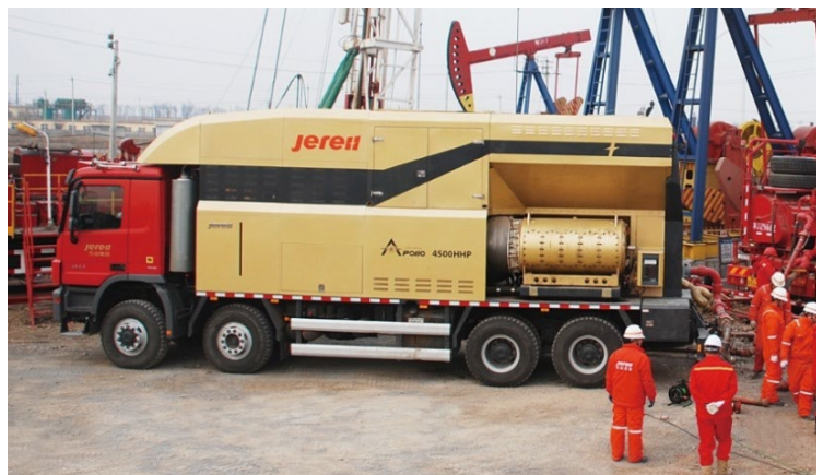
在现场试运行中的 4500 水马力 Apollo1 水力压裂拖车
