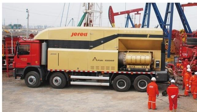
El Remolque de Fracturación Hidráulica Apolo 1 en Pruebas de Campo.
