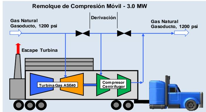
Las turbinas de gas ASE son adaptaciones de las probadas turbinas aero derivadas, configuradas específicamente para aplicaciones de generación de potencia energía y compresión.
