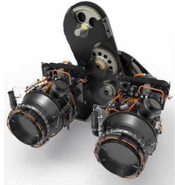
在其他的船舶系统，提升和推进动力装置在舰船上是完全独立放置 因为TF发动机双轴设计，他们可以与同步离合器成对配置，在船舶运行时，允许发动机随时上线运行，或停机关闭，以使效率最大化。
